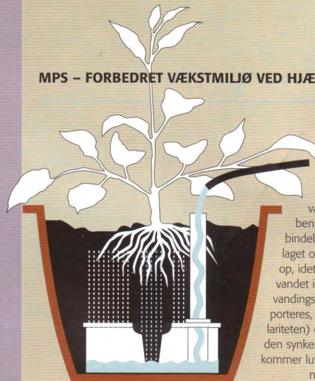
Mona Tank 1,5 Vandindhold: 1,4 l Diameter 18 cm, Højde 6,5 cm Påfyldningsrør 33,5 cm
