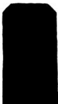
Alternative asbestcement tagsten i 30 x 60 cm. 12,6 stk. pr. m 2 tagflade.
