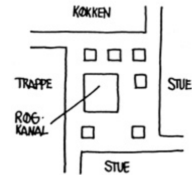
Skorstensrør og ventilationsrør.
